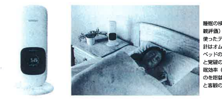
睡眠の検証は、住まい手に対するアンケート（主観評価）に加え、協力者のうち33人に睡眠計を使ったデータ測定（客観評価）も実施した。睡眠計はオムロンヘルスケアの「HSL-101」を使用。ベッドの横に置き、就寝から起床までの間、睡眠と覚醒の状態を測定する。このデータを使い、睡眠効率（総就床時間から中途覚醒時間を引いたものを総就床時間で割った数値）を算出した。主観と客観の評価の結果はほぼ一致していた (写真：オムロンヘルスケア)
