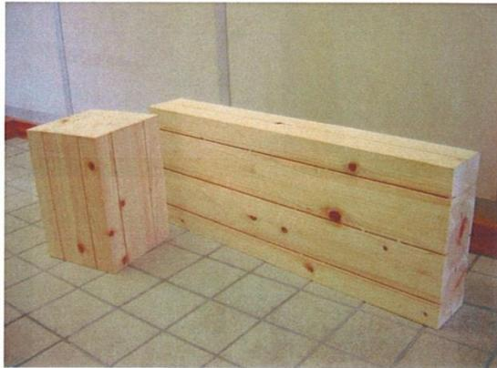
乾燥精度の高い桧四面背割材を集成技術を用いて接着することにより、安定した強度と精度を併せ持つ高性能の構造材となります。
