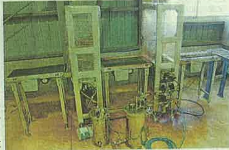
内装材の着色に使う自動塗布装置
